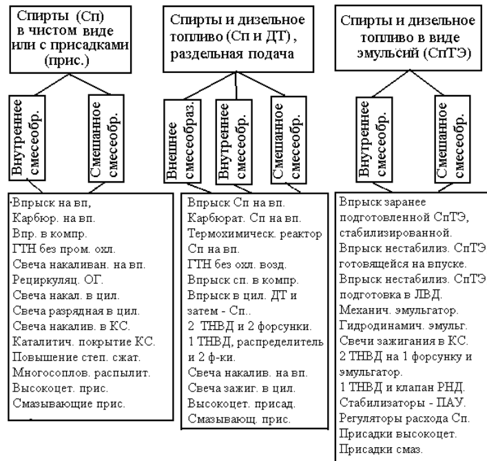
Рис.1.9.4. Методы организации рабочих процессов дизелей, использующих спирты в качестве альтернативных топлив
