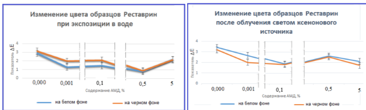
Рисунок 9. Изменение цвета образцов композитного материала «Реставрин» в зависимости от концентрации введенного ХГА
