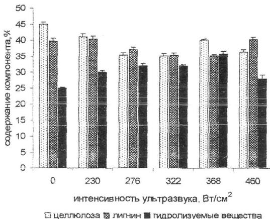
Рисунок 4 - Зависимость остаточного содержания компонентов растительного материала от интенсивности ультразвука
