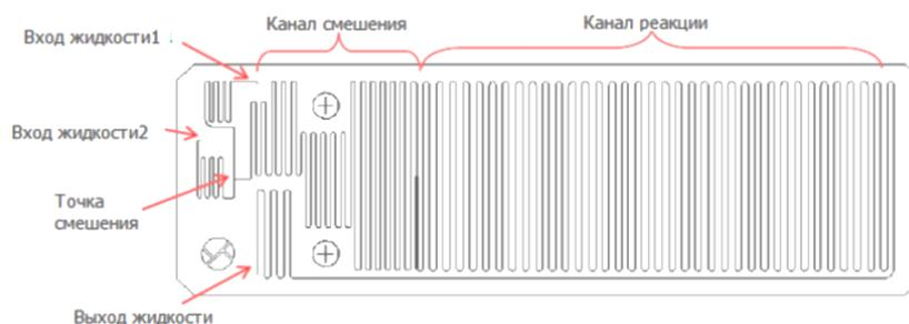
Рисунок 4. Конструктивная схема чипа-микрореактора.
