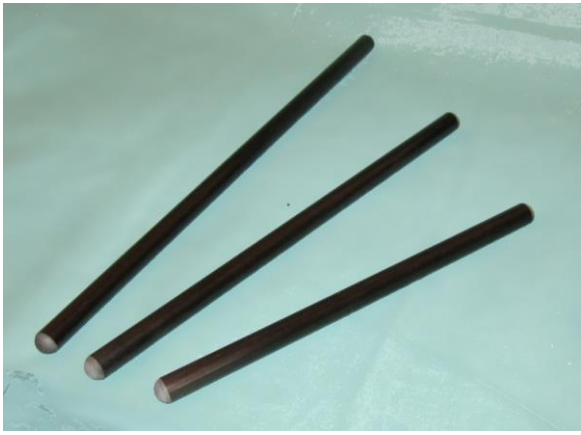
Рисунок 6 – Внешний вид стекловолоконных штанг внешней опоры
