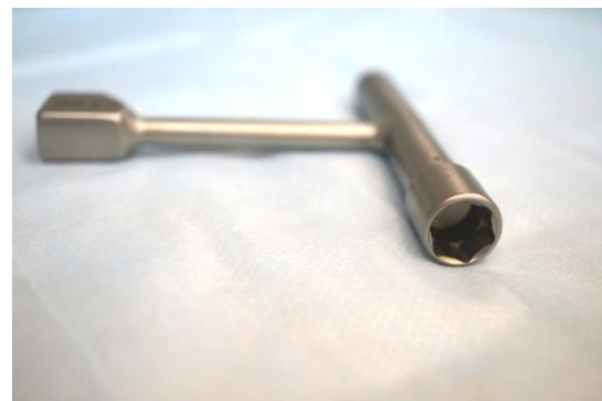
Рисунок 3 – Внешний вид Т-образного универсального ключа для ручного введения стержней и затягивания гайки фиксатора
