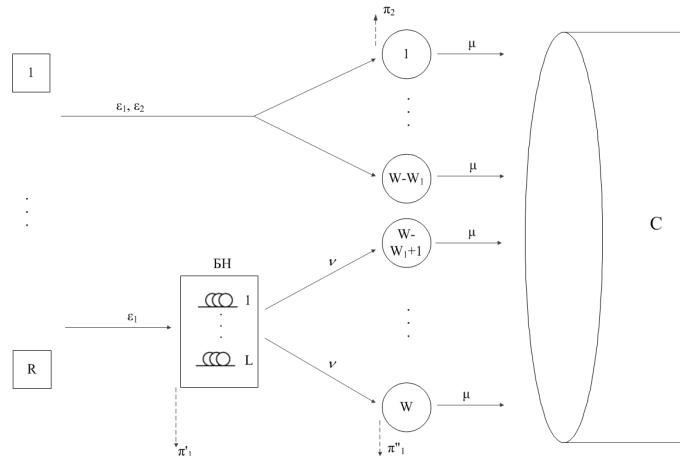
Рис. 2. Принцип работы оптического коммутатора
