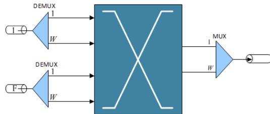
Рис. 1. Архитектура оптического коммутатора типа О-О-О
