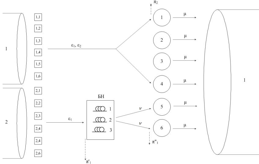
Рис. 4. Пример принципа работы оптического коммутатора с FDL
