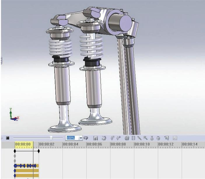
**Рис. 2.** Модель для кинематического и силового анализа газораспределительного механизма
