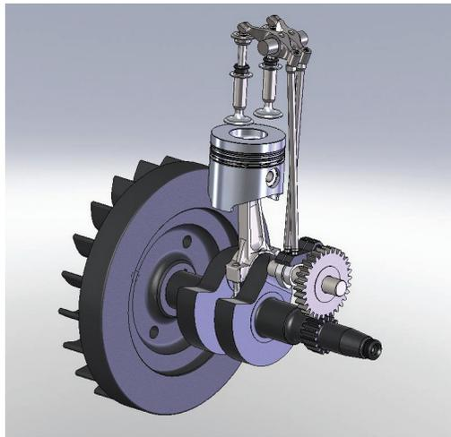
**Рис. 1.** Трехмерная сборочная модель кривошипно-шатунного и газораспределительного механизмов двигателя МД-8
