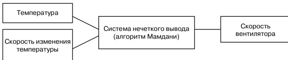
Рис. 3. Принцип нечеткого управления Мамдани скоростью вентилятора
