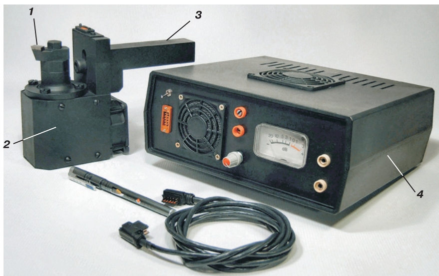
Рис. 2. Прибор для точения с применением ультразвуковых колебаний, разработанный национальной технологической группой: 1 — резец; 2 — вибратор; 3 — державка; 4 — усилитель мощности
