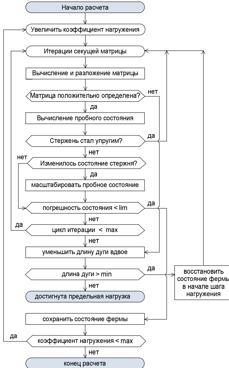
Рис. 2. Структурная схема алгоритма расчета фермы на предельную нагрузку
