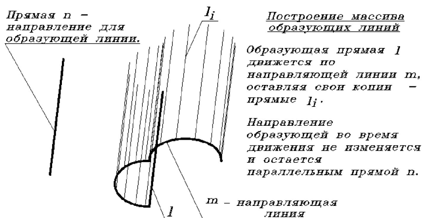
Рис. 3. Построение массива каркасных линий
