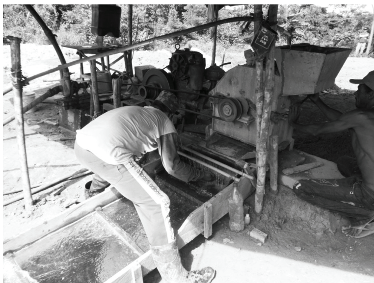
Рис. 4. Подготовка амальгамационного шлюза к работе
