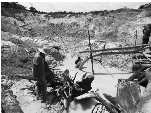
Рис. 2. Карьерная отработка гаримпейрос верхней части золотоносной жилы, дезентегрированной процессами латеритного выветривания
