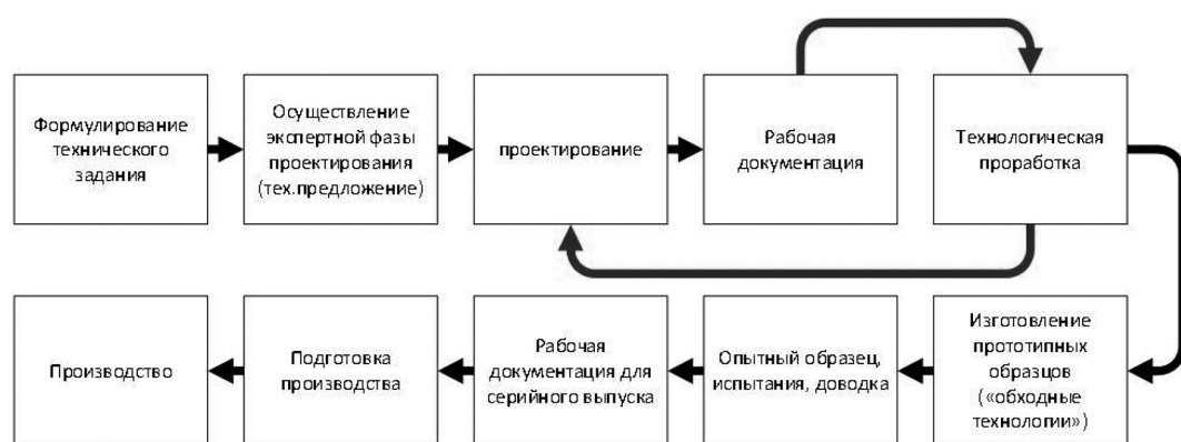
Рис. 3. Общая схема цикла проектирования и подготовки производства промышленных изделий
