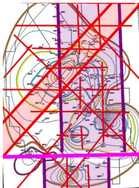
Рис. 4. Самотлорский геодинамический полигон. Схема сопоставления локальной линеаментно-блоковой модели с картой мульд оседания земной поверхности
